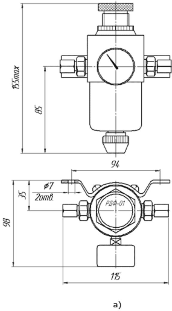
Рис. 1. Габаритные и установочные размеры для редуктора РДФ-01-1.
