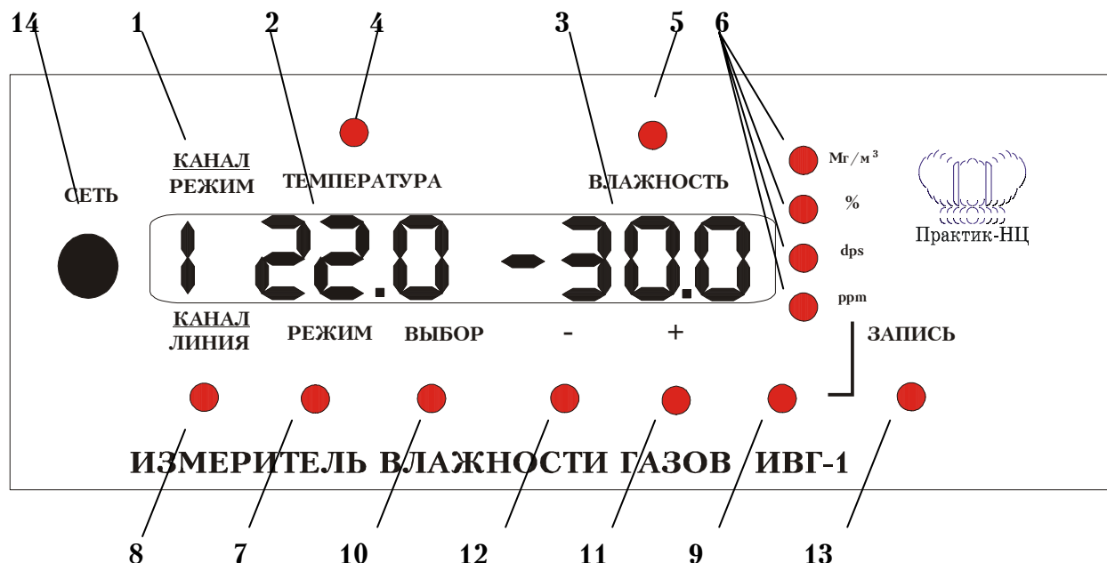
Рис. 1. Расположение элементов управления и индикации на передней панели прибора
