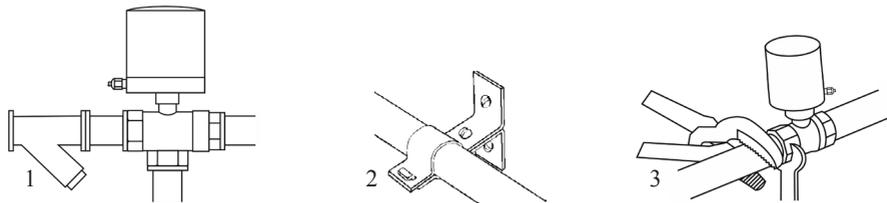
1. Перед монтажом крана трубопроводы должны быть прочищены, т.к. попадание в кран инородных частиц может привести к выходу его из строя. Перед входным отверстием крана необходимо установить фильтр-грязевик.
