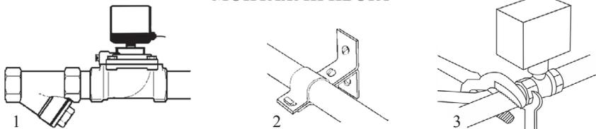
1. Перед монтажом крана трубопроводы должны быть прочищены, т.к. попадание в кран инородных частиц может привести к выходу его из строя. Перед входным отверстием крана необходимо установить фильтр-грязевик.
