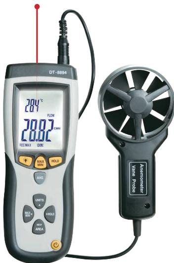
Термоанемометр DT-8894 предназначен для измерения скорости, объемного расхода и температуры воздушного потока.
