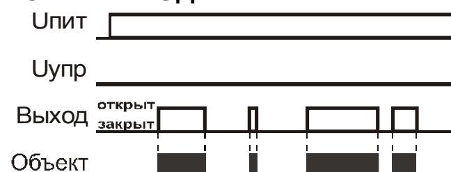
Работа выхода в режиме «dark on»
