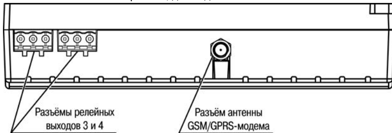
Рисунок 3.2 – Вид на верхнюю поверхность ПЛК323
